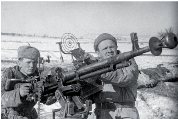
Рис. 82 Крупнокалиберный зенитный пулемет Дегтярёва-Шпагина (ДШК) калибра 12,7 мм, с 1944 года устанавливался и на танках ИС-2.
